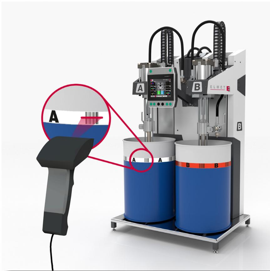
ELMET hat die Bediensicherheit im Silikonspritzguss jetzt noch weiter perfektioniert. Ein gemeinsam mit dem Chemiekonzern WACKER entwickeltes Barcodesystem zur zuverlässigen Unterscheidung der Komponenten A und B und eine entsprechende Lesevorrichtung am Komfort-Dosiersystem TOP 5000 P verhindern zuverlässig das Vertauschen beim Fasswechsel und damit immense Folgekosten. © ELMET
