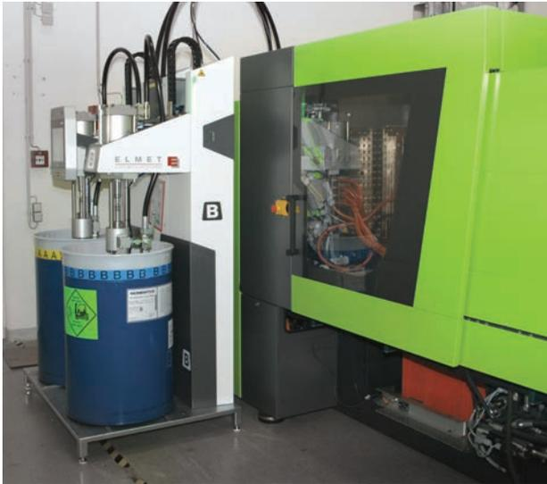
*Durch die neue, offene Bauweise des »Top 5000 P«-Dosiersystems sind die Gebinde nun von vorne und von der Seite bequem tauschbar.*
