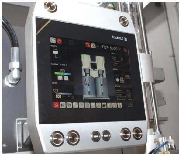
Bedienstation mit Stil: Das 12“-Multitouch-Panel mit Glasfront »ETT 1233-EL« von Sigmatek eingebettet in ein eloxiertes Aluminiumgehäuse. Die Visualisierung wurde mit dem HMI-Tool »Lasal Screen« erstellt.
